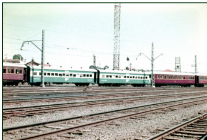
▲ No mesmo Trem do Pantanal, a fase de transição dos carros de madeira para os de aço carbono. Foto: Guido Motta.
