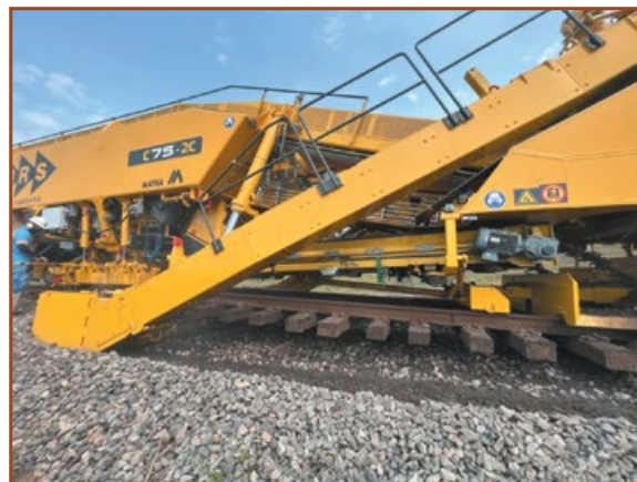
▲ Desguarnecedora Total de Lastro C-75 fabricada pela MATISA e de propriedade da MRS Logística (Foto: Caio Netto)
