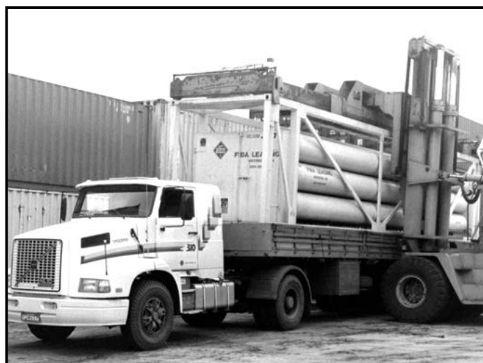
▲ Carregamento de um contêiner tanque de 40 pés no Arará, por uma empilhadeira de grande porte. Foto: João Bosco Setti
